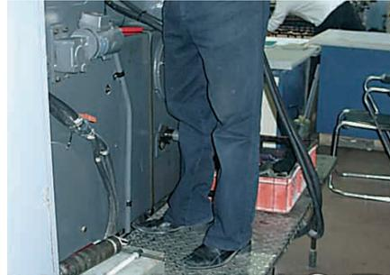
El uso de plataformas estables permite a los trabajadores operar ciertas máquinas con mayor comodidad. Son especialmente útiles para facilitar el acceso a mandos o controles de equipos situados a cierta altura.
