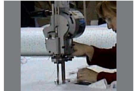
La producción de varias piezas iguales de manera simultánea, como en esta cortadora de tela, permite ahorrar mucho tiempo e incrementar la productividad, con la condición de que se logre mantener la calidad y la seguridad de la tarea.
