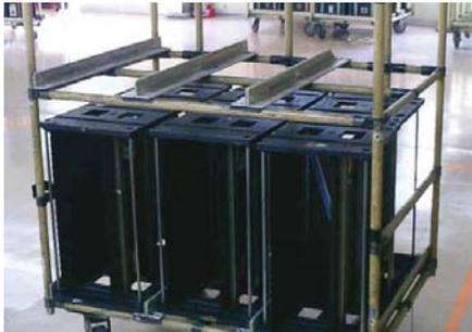
Carros sobre ruedas con materiales o partes en proceso desplazables fácilmente entre puestos de trabajo y que pueden ser diseñados según las necesidades específicas de la empresa.
