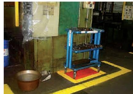
Las líneas pintadas en colores visibles en el suelo permiten que los pasillos de circulación se mantengan despejados para facilitar el desplazamiento de trabajadores y materiales.
