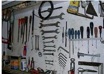
Paneles o armarios de bajo costo fabricados artesanalmente para guardar herramientas, que permiten encontrarlas rápidamente y controlar su existencia, logrando una mayor eficiencia en las tareas.
