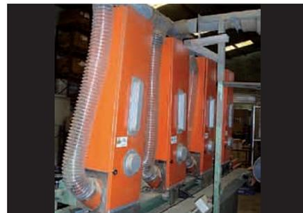
Un sistema flexible de aspiración de polvo metálico de pulido colocado cerca de la parte del equipo donde se genera permite su extracción y evita su aspiración por los trabajadores, mientras ayuda a mantener limpio el puesto de trabajo y asegura productos de mayor calidad.
