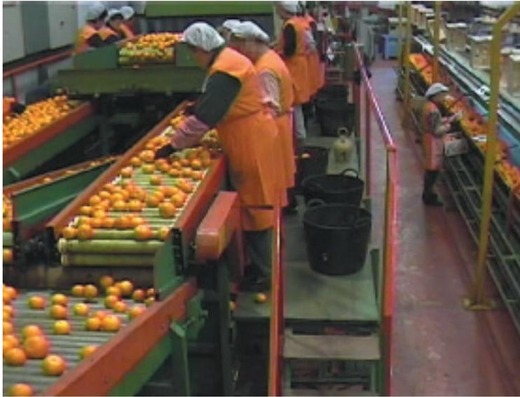
La trabajadora inspecciona las piezas de fruta (naranjas) que van pasando sobre una cinta transportadora, desechando las piezas defectuosas. Coge las naranjas defectuosas, empleando ambas manos, y las deposita en unos conductos situados en un lateral de la cinta a ambos lados de la trabajadora.
