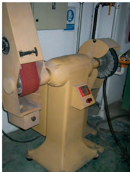
En caso de máquinas o equipos que impliquen sujeción manual de las piezas (como los equipos de pedestal), estos deberán disponer de resguardos de protección laterales que impidan el acceso a partes móviles giratorias para evitar los posibles riesgos de atrapamiento. También dispondrán de resguardos frontales de protección que cubran la mayor parte posible del disco / muela / banda, sin impedir o dificultar la realización del trabajo por parte del operario.
