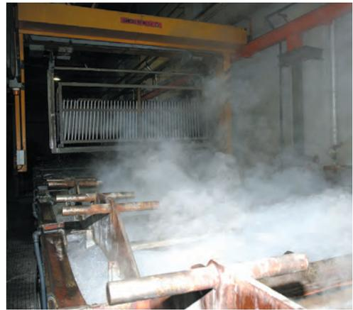
Las nieblas procedentes de los sistemas por aspersión o de los gases desprendidos pueden constituir un riesgo grave para la salud. La formación de niebla aumenta con la cantidad de piezas a procesar, la temperatura, la acidez de la disolución, y la densidad de corriente en la limpieza electrolítica. Las nieblas contienen todos los ingredientes de la mezcla, por lo que es necesaria una buena ventilación.
