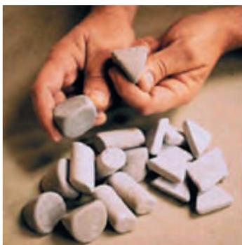
Las cargas abrasivas se suelen fabricar con materiales naturales (granito, piedra caliza, etc.), materiales artificiales (alúmina, carburo de silicio, etc.) o materiales cerámicos (chips). También se utilizan chips de material plástico.
