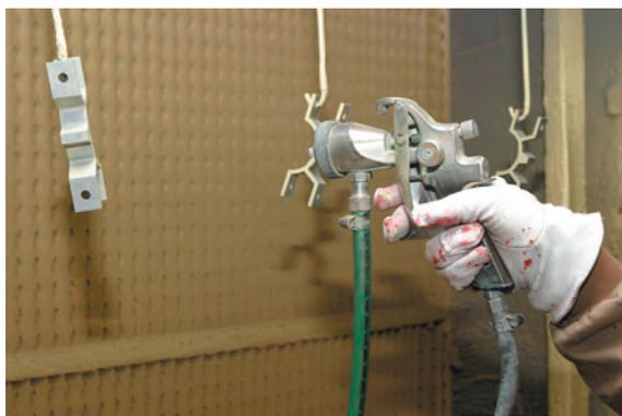
**Electrostática:** consiste en utilizar las fuerzas de un campo electrostático elevado para favorecer la formación y la división de las partículas de pintura dentro de la niebla de pulverización.
