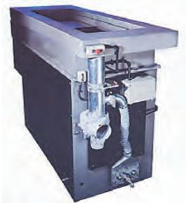
En algunos casos, el desengrase al disolvente también puede ser empleado como hidrofugante para la eliminación de agua de piezas recubiertas, un procedimiento común en la industria de la joyería, herraje y otros objetos decorativos. Para ello se utilizan mezclas azeótropas de agua / disolvente que contienen humectantes específicos para evitar las manchas calcáreas.
