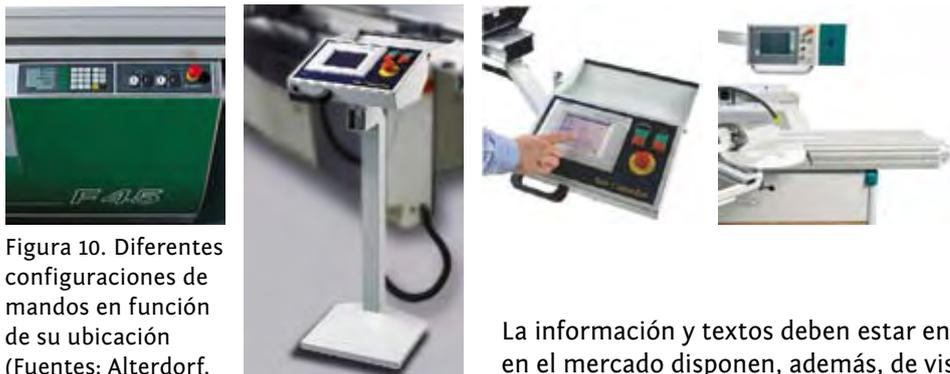
Figura 10. Diferentes configuraciones de mandos en función de su ubicación (Fuentes: Alterdorf, Haco y Griggio).
