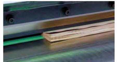
Figura 8. Haz luminoso indicador de corte (Fuente: Casati Macchine).
