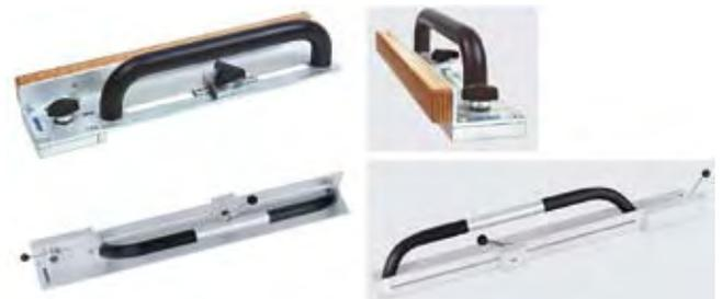
Figura 7. Dispositivos de sujeción de la pieza (Fuente: Aigner).
