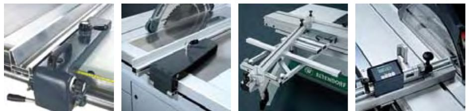
Figura 9. De izquierda a derecha: tope-guía con asidero, tope-guía paralelo electromotriz, tope-guía transversal de inglete e inglete dotado de visualización digital con ajuste de precisión (Fuentes: HACO y Altendorf).
