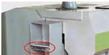
Figura 3. Sistema de fijación de los carriles de prolongación (Fuente: Aigner).
