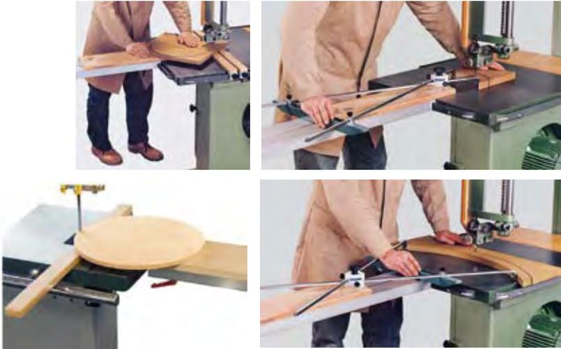
Figura 5. Circulo de fresado y segmentador (Fuentes: Aigner, Felder).
