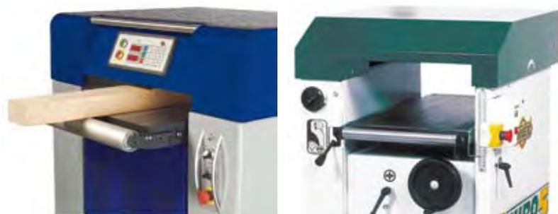
Figura 2. Rodillos de apoyo (Fuentes: Felder, Rojek).
