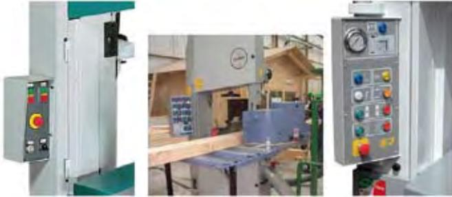
Figura 9. Mejora de la visibilidad de los dispositivos de información y mando (Fuentes: Griggio, Meber, Agazzani).
