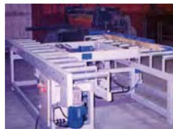
Figura 8. Sistemas de retorno a la salida y giradores de molduras (Fuente: Euromak, Digarma).
