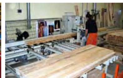
Figura 5. Sistemas de acumulación a la entrada y salida de máquinas (Fuente: Bottene).
