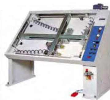
Figura 6. Prensa para cajones (Fuentes: Omec, Siti di Basso).
