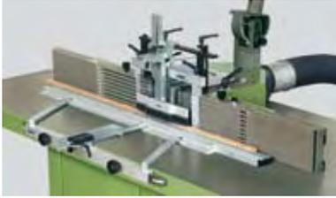
Figura 20. Fresado de una pieza fina y estrecha en la regla adicional con placas de presión y patín oscilante (Fuente: Aigner).
