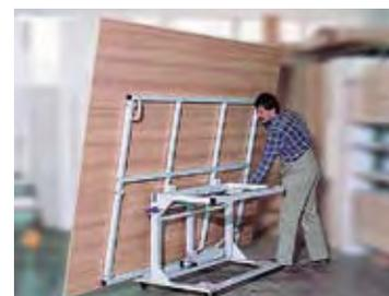
Figura 2. Carro de transporte de tableros (Fuente: Schmalz).
