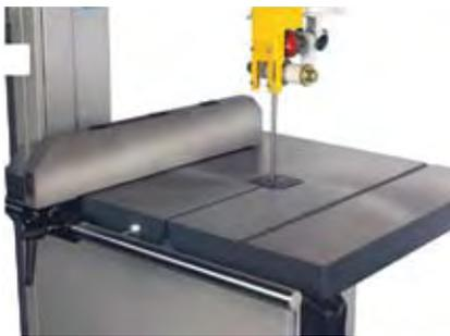
Figura 2. Regla de corte paralelo (Fuente: Felder).
