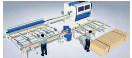
Figura 7. Descarga de las piezas de la moldurera (Fuente: Weinig).
