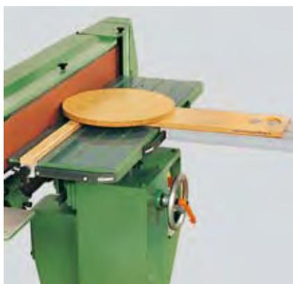
Figura 3. Circulo de fresado en la lijadora (Fuentes: Aigner)
