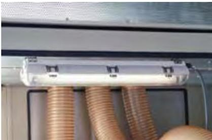
Figura 9. Lámpara para evitar el efecto estroboscópico (Fuente: Weinig).
