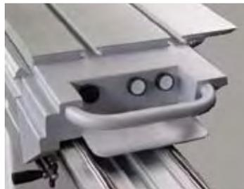
Figura 3. Interruptores en el carro (Fuentes: Altendorf, Martin, Griggio).
