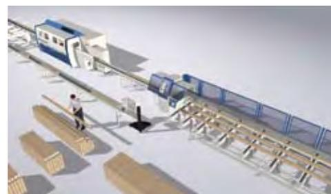
Figura 6. Combinación de sierras y sistemas de transporte de material (Fuente: Weinig).
