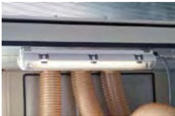
Figura 10. Lámpara para evitar el efecto estroboscópico (Fuente: Weinig).
