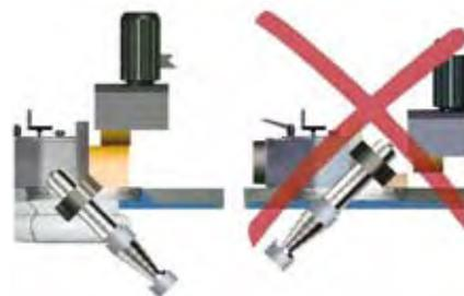
Figura 25. Inclinación del eje “hacia atrás” (Fuente: Felder).
