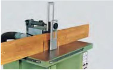
Figura 5. Fresado de una pieza en posición vertical (Fuente: Aigner).
