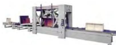
Figura 3. Prensas con bandas transportadoras (Fuentes: Ramarch, Italpresse).
