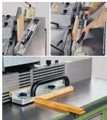
Figura 8. Ejemplos de aplicación de los dispositivos de sujeción (Fuente: Aigner).
