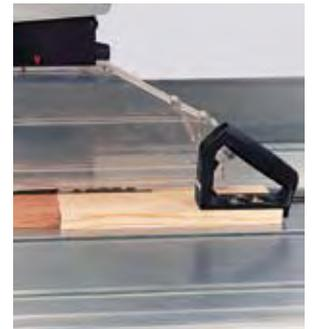
Figura 6. Empujador con empuñadura (Fuente: Aigner).
