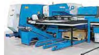
Figura 1. Máquina que integra cizalla y punzonadora (Fuente: Finnpower).
