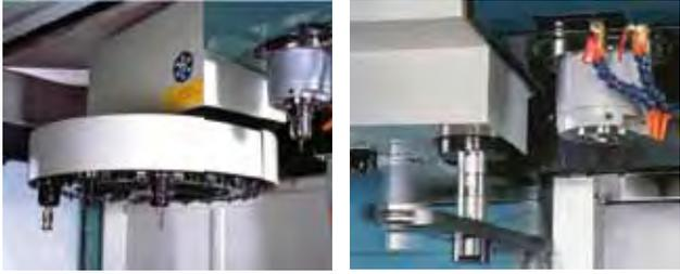
Figura 7. Cambiador automático de herramientas (Fuente: Famasa).
