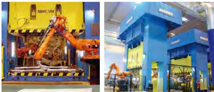
Figura 15. Prensas con robot (Fuentes: Loiresafe).
