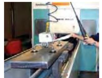
Figura 13. Elevador por vacío (Fuente: Schmalz).
