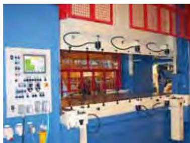
Figura 13. Sujeción rápida del troquel (Fuente: Arisa).
