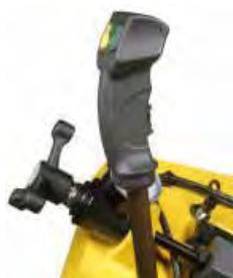
Figura 13. Botones en la empuñadura (Fuente: MG).
