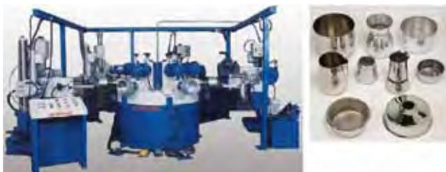
Figura 13. Lijadora para ollas y cacerolas (Fuente: Autopulit).
