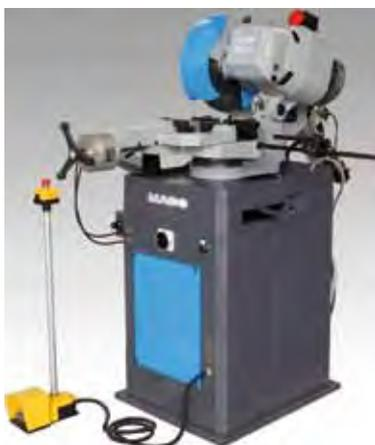
Figura 4. Tronzadora automática (Fuente: Macc).
