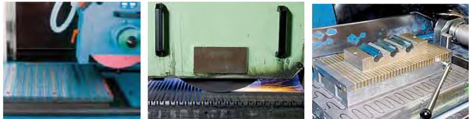
Figura 5. Placas magnéticas (Fuente: Schunk).
