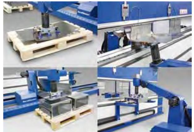
Figura 5. Sistema de manutención de piezas robotizadas (Fuente: Trumpf).
