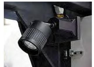
Figura 18. Lámpara de posicionado (Fuente: Danobat).
