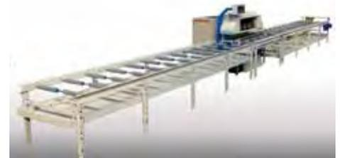
Figura 9. Transportador de rodillos (Fuente: Autopulit).
