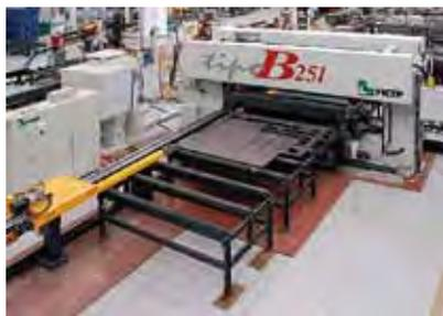
Figura 2. Cizalla, punzonadora y taladro CNC (Fuente: FICEP).
