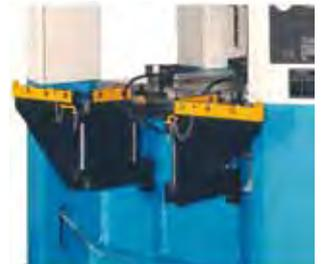
Figura 10. Brazos de carga de herramientas (Fuente: Bliss).
