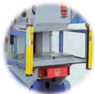
Figura 17. Barrera de seguridad (Fuente: EMGpresses).
