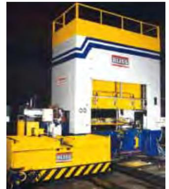
Figura 11. Carro portaherramienta (Fuente: Bliss).
