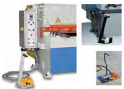
Figura 3. Pedales de seguridad para controlar los ciclos (Fuentes: Ermaksan, Durma, Femas).
