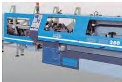
Figura 5. Tronzadora CNC automática (Fuente: Macc).
