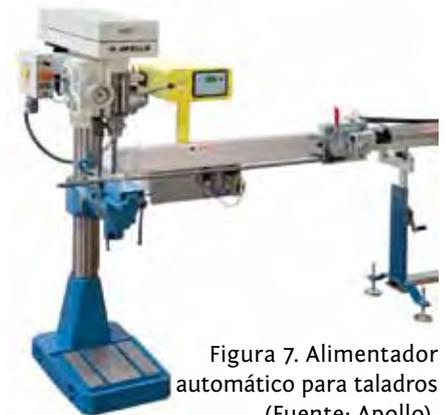
Figura 7. Alimentador automático para taladros (Fuente: Apollo).
