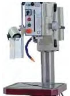
Figura 14. Taladro dotado de lámpara de trabajo (Fuente: Heller).
