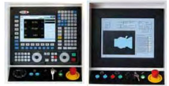
Figura 16. Control numérico con diferentes pantallas
