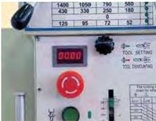
Figura 12. Detalle display digital (Fuente: Heller).
