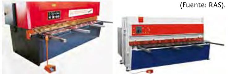
Figura 5. Cizallas con sistemas de soporte (Fuentes: Durma, Korpleg).
