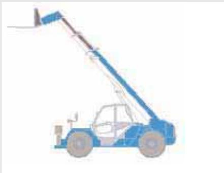
La manipuladora telescópica es un vehículo utilizado en las obras de construcción para el transporte de materiales entre diferentes zonas y el posicionamiento de éstos en las zonas de trabajo.
