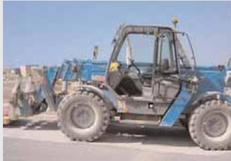
Figura 59: Manipuladora telescópica
