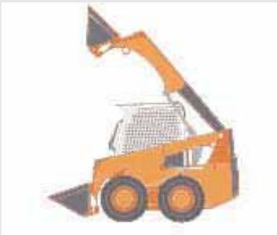
El vehículo se emplea en tareas de construcción para la carga de material (grava, tierra, hormigón, etc.) y su traslado hasta zonas de difícil acceso para otro tipo de vehículos dada su envergadura, así como para la excavación en lugares donde las excavadoras tradicionales no pueden acceder.
