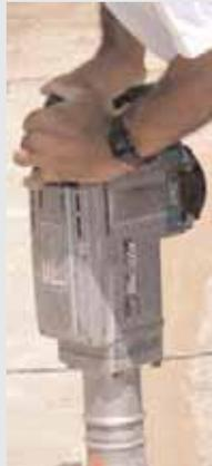
Se usa fundamentalmente para la realización de agujeros y para la rotura de terrenos de diferente naturaleza, sobre todo de cemento, así como para la realización ocasional de zanjas.
