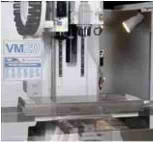
Figura 15. Mesa de trabajo con iluminación localizada (Fuente: Milltronics).
