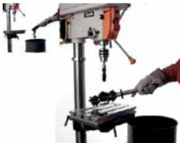
Figura 16. Accesorio magnético para la limpieza y recogida de virutas (Fuente: Bessey).
