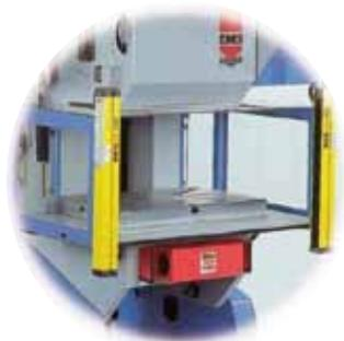
Figura 17. Barrera de seguridad (Fuente: EMGpresses).
