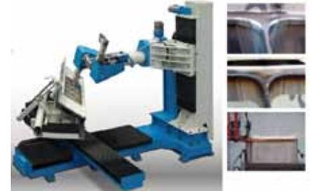
Figura 1. Lijadora para limpieza de soldadura (Fuente: Autopulit).
