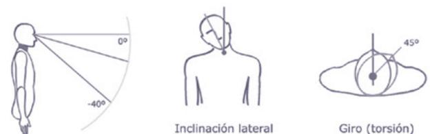
Figura 17. Zonas para la línea de visión (dirección de la mirada), para la flexión lateral y torsión del cuello.
