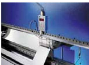
Figura 9. Sensor de ángulos (Fuente: Trumpf).
