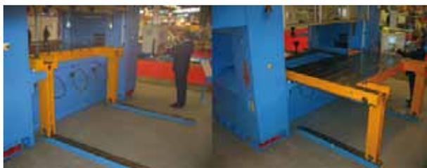
Figura 9. Sistemas para la introducción rápida del troquel (Fuente: Arisa).
