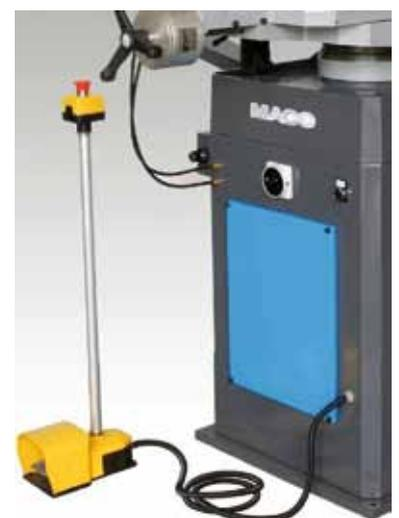
Figura 10. Pedal de accionamiento (Fuente: Macc).
