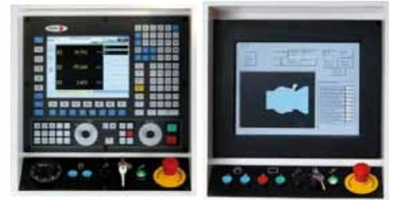
Figura 16. Control numérico con diferentes pantallas
