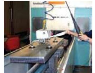
Figura 13. Elevador por vacío (Fuente: Schmalz).
