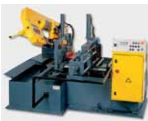
Figura 4. Tronzadora automática (Fuente: MG).
