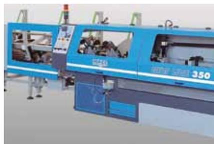
Figura 5. Tronzadora CNC automática (Fuente: Macc).
