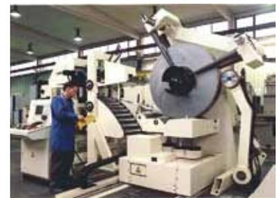
Figura 6. Sistemas de alimentación para prensas (Fuente: Agfra).
