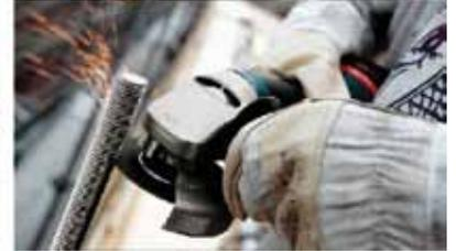
Figura 12. Amoladora a batería (Fuente: Bosch).
