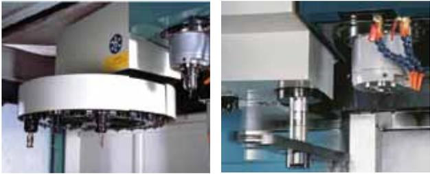
Figura 7. Cambiador automático de herramientas
