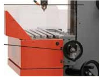
Figura 15. Ranura en forma de T (Fuente: EMCO).
