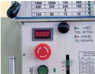
Figura 12. Detalle display digital (Fuente: Heller).
