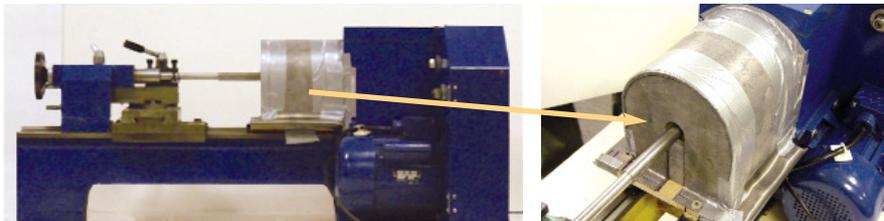
**Figura 13.** Encapsulado de uno de los cabezales del torno.
