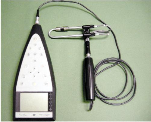
En la práctica, un sistema de medida de la intensidad consta de una sonda y un analizador (**Figura 5**). La sonda esta formada por dos micrófonos encargados de medir la presión en dos puntos muy próximos entre sí, y el analizador realiza la integración y los cálculos necesarios para obtener la intensidad sonora.
